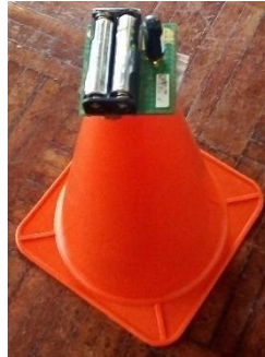
Figura 3.2. Ubicación del transceptor RCB256RFR2 en el cono.
