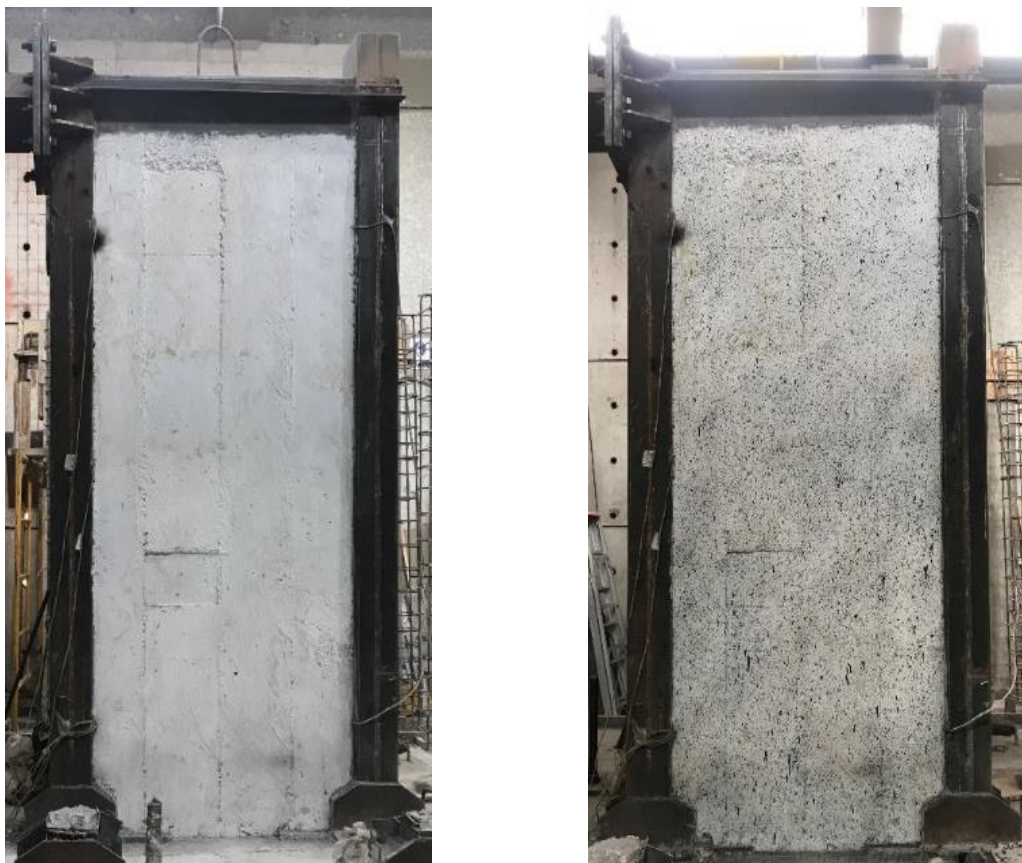
Figura 3-11. Preparación de la superficie para el DIC Elaborado por: Cabrera & Quintana
