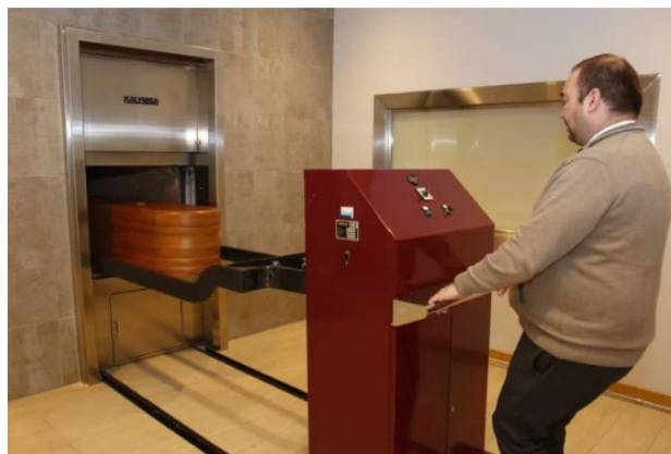
Figura 26. Carro mortuario autoextraíble.
