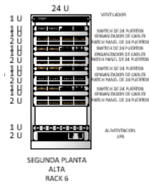
Figura F.6. Diagrama del rack 6 en el edificio de la Secretaría del Agua.
