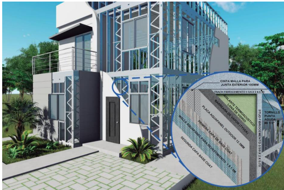
Figura 5. Sistema Drywall o en seco.
