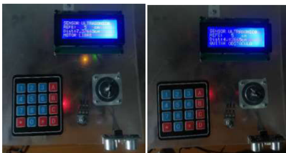
Figura 3.42 Cumplimiento del motor Bipolar en función del sensor ultrasónico
