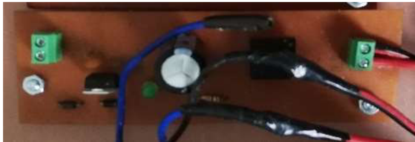
Figura 3.25 Placa PCB de la fuente de 5 ( V_{DC} )
