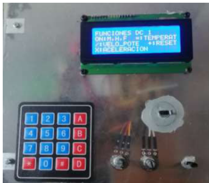
Figura 3.39 Menú del módulo de control del motor DC
