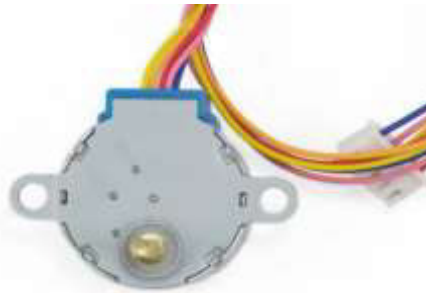
Figura 3.13 Motor unipolar 28BYJ-48-5V. [8]
