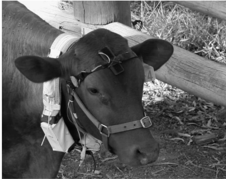
Figura 1.2. Dispositivo de estímulos eléctrico, auditivo y visual de experimentación de cercado virtual. [8]
