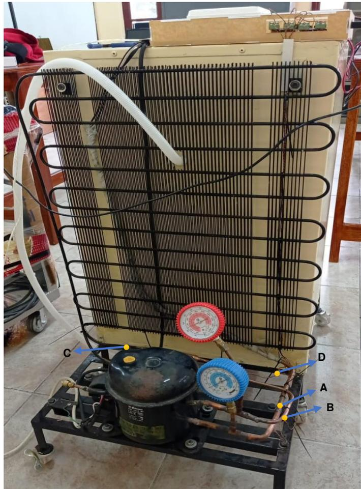
**Figura 3.6** Instalación de las termocuplas en el Equipo 1
