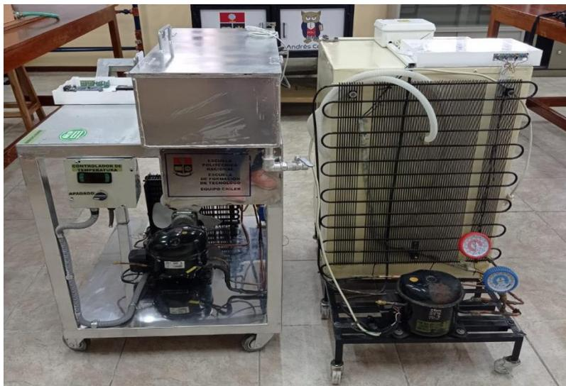
**Figura 3.26** Equipo Chiller (Equipo 2) y enfriadora de leche (Equipo 1)
