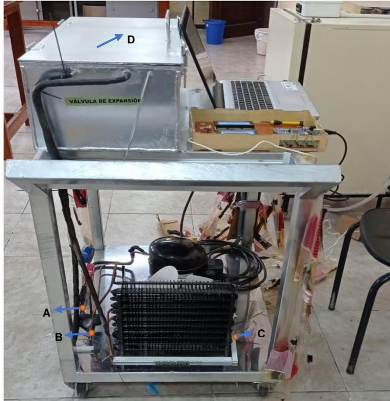
**Figura 3.7** Instalación de termocuplas en el Equipo 2
