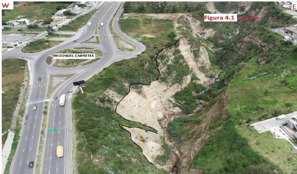
Figura 4.2 Fotografía aérea tomada por VANT en donde se puede visualizar movimientos en masa dentro de la Quebrada Carretas marcados sus escarpes en color negro y las capas de cenizas volcánicas en naranja.
