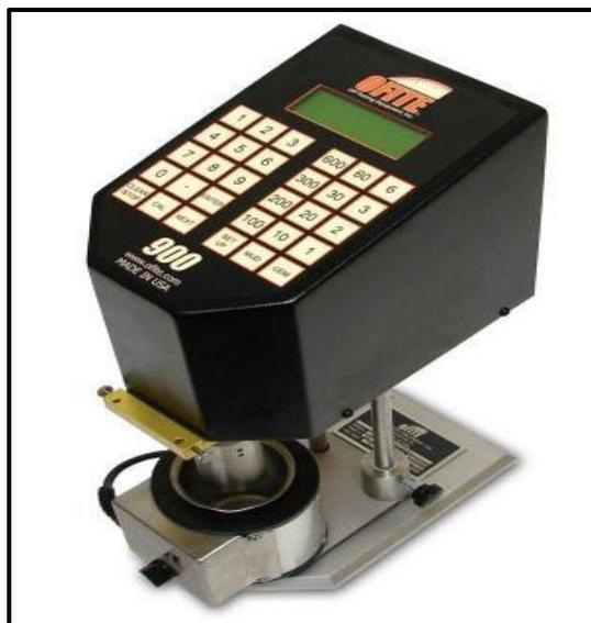
**Figura 3.5** Viscosímetro modelo 900
