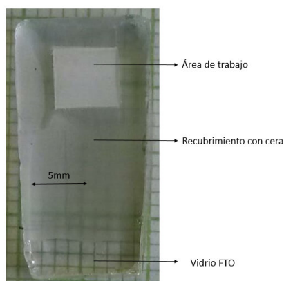
Figura 2.11: Electrodo de trabajo. Placa de vidrio FTO con deposición de TiO_2 en un área aproximada de 22mm^2
