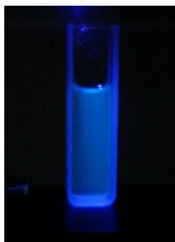
Figura 3.3: Fluorescencia de los GQD, excitados con luz UV de 403\text{nm}
