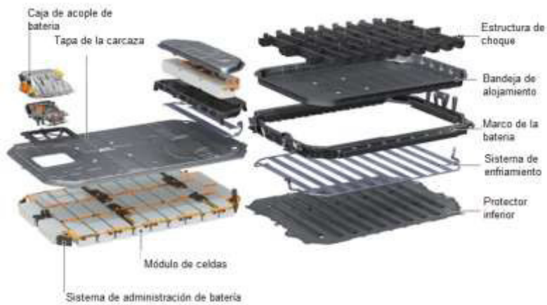
Figura 41 Batería Bus Eléctrico [28]
