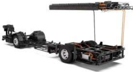
Figura 4 Ubicación de baterías de almacenamiento [4]
