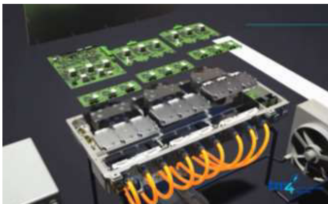
Figura 13 Estructura interna Inversor [16]
