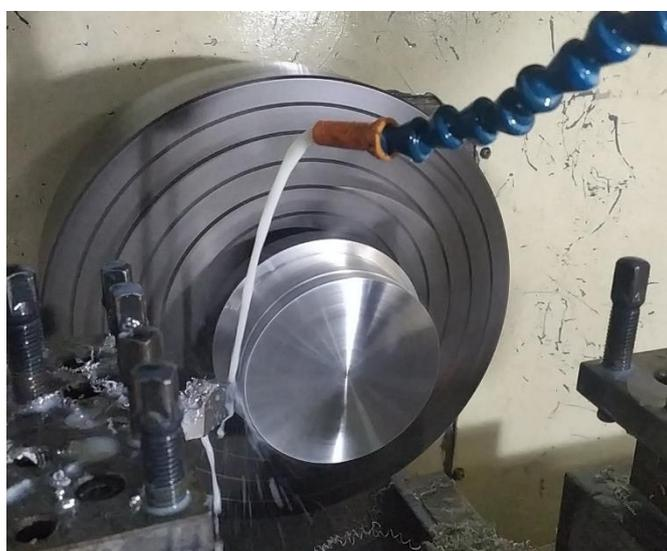
Figura 2.43. Asiento del molde mecanizado etapa uno.
