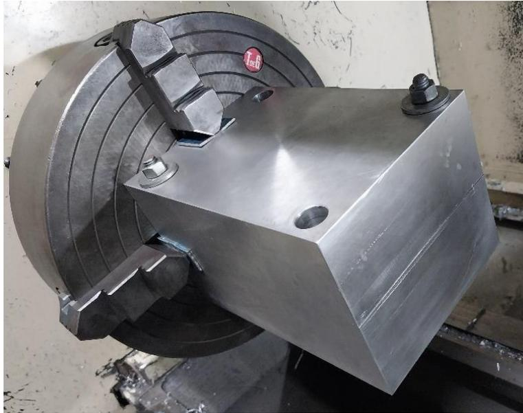
Figura 2.38. Cuerpo del molde ensamblado.
