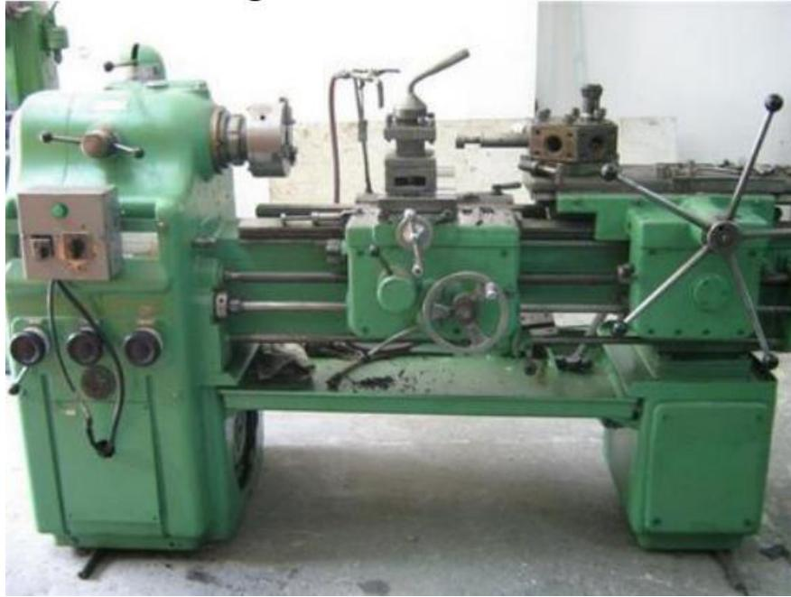
Figura 1.12. Torno tipo revolver.
