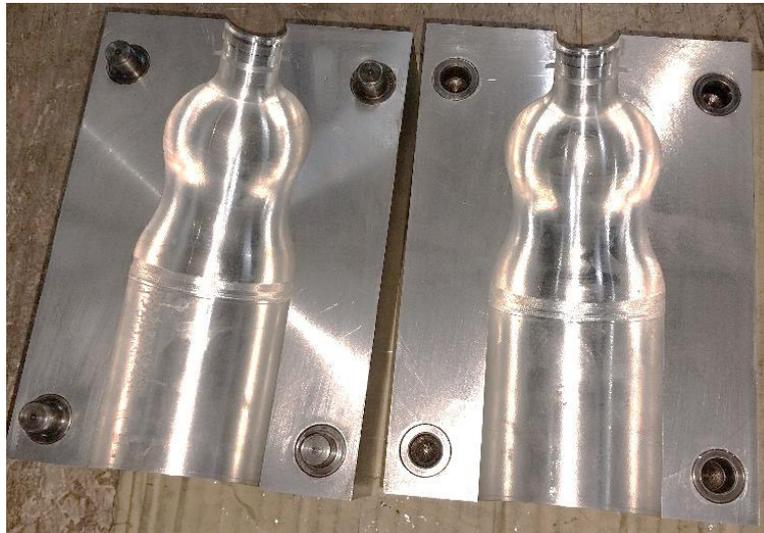
Figura 2.42. Mecanizado de la forma de la botella.
