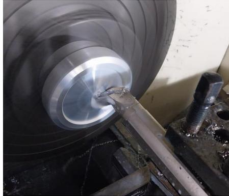
Figura 2.45. Cilindrado interno de la base de la botella.
