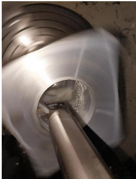
Figura 2.41. Desbaste con inserto DCMT11T304.
