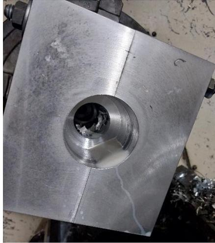
Figura 2.40. Resultado de la perforación de la cavidad interna del molde.
