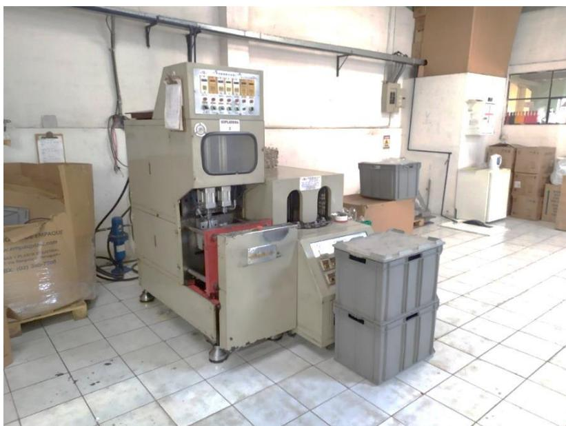
Figura 1.16. Sopladora para botellas de plástico.
