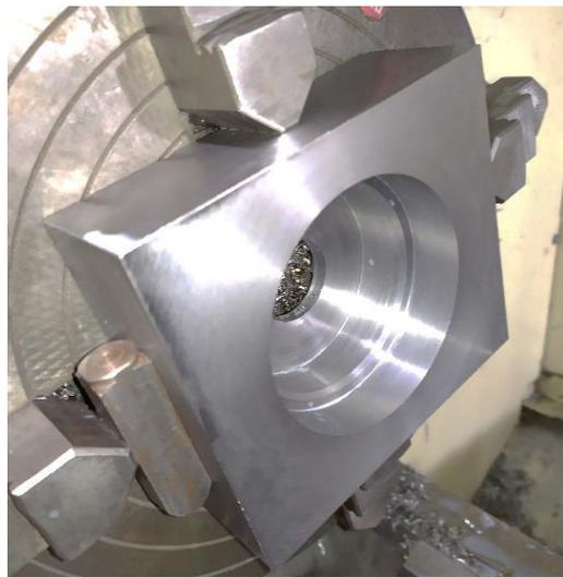
Figura 2.48. Mecanizado de la base del asiento.
