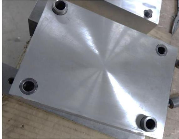
Figura 2.36. Colocación de pines y bocines en el cuerpo del molde.
