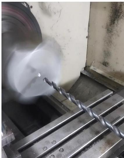
Figura 2.39. Perforación de la cavidad interna del molde.
