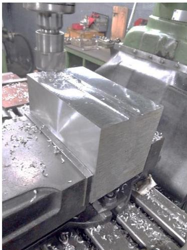
Figura 2.27. Rectificado de placas de duraluminio mediante proceso de fresado.
