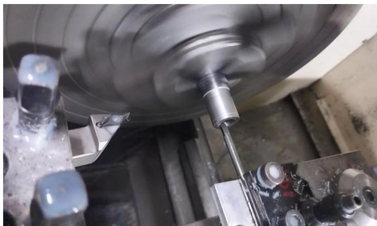
Figura 2.35. Cilindrado interno
