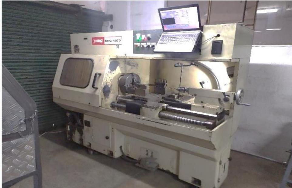
Figura 1.11. Torno CNC-marca Yang SNC-4070
