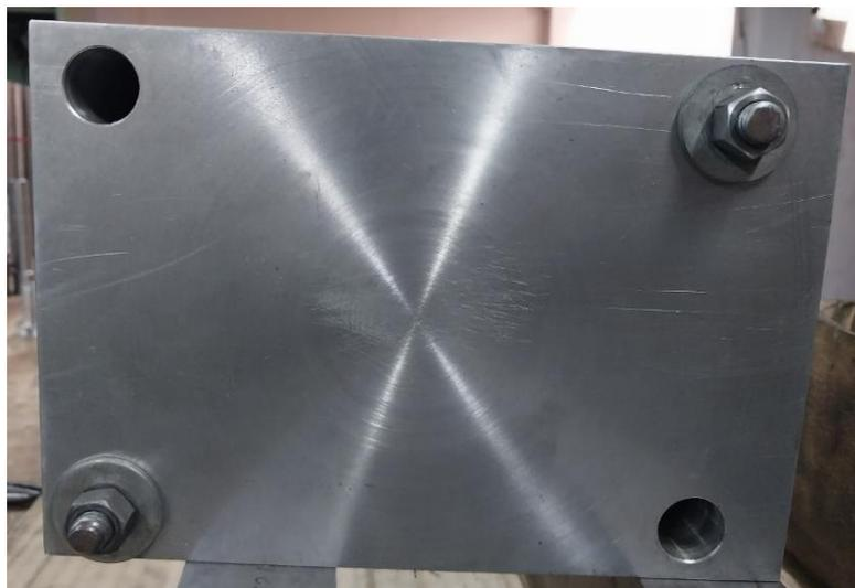
Figura 2.37. Colocación de espárragos en el cuerpo del molde.
