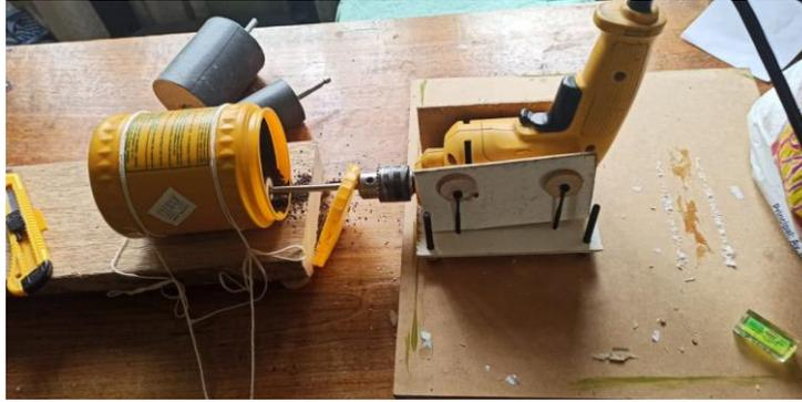
Figura 2.25 Modelo de experimentación para máquina de desbaste.
