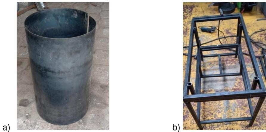
Figura 2.49 (a) Recipiente rolado. (b) Soldadura de estructura base.
