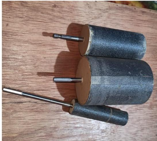
Figura 2.27 Arreglo de rodillos tipo revolver
