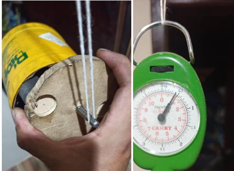
Figura 2.28 Medición de fuerza aplicada en el extremo
