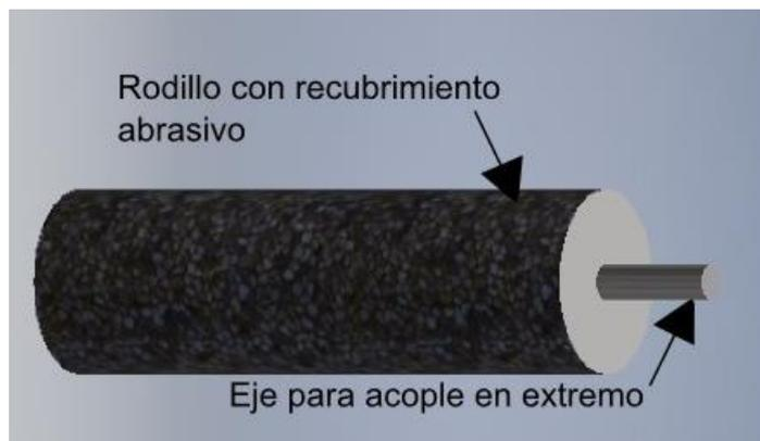
Figura 2.14 Esquema de un rodillo con recubrimiento de alta rugosidad
