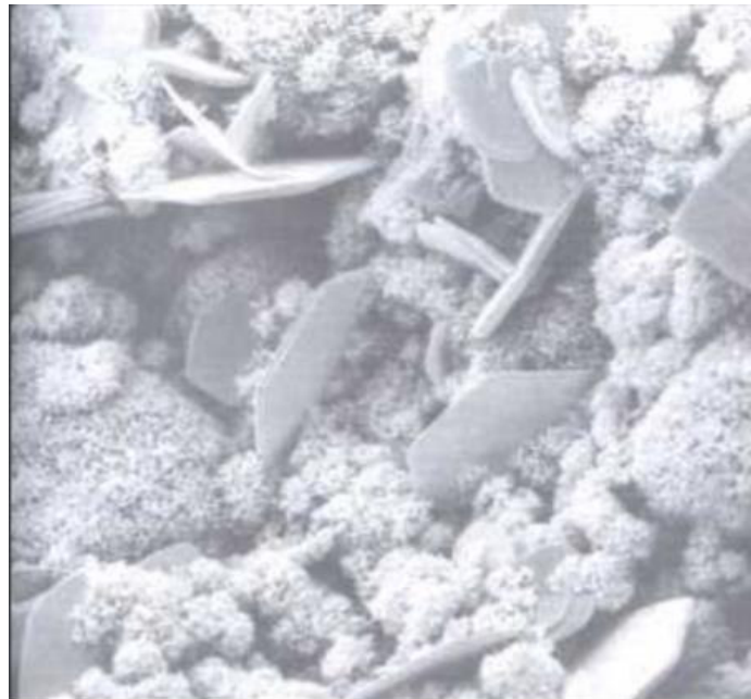
Figura 1. 8 Pasta de cemento hidratada Ca(OH)_2 y C – S – H
