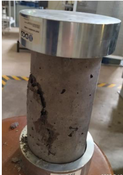
Figura 3. 2 Ensayo a compresión
