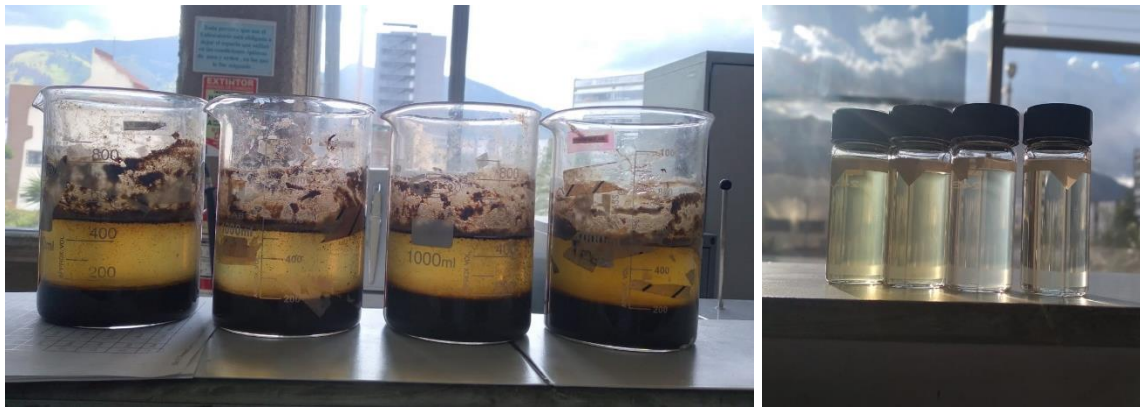
Figura 29. Segunda prueba de tratabilidad (Dosis óptima de coagulante)
