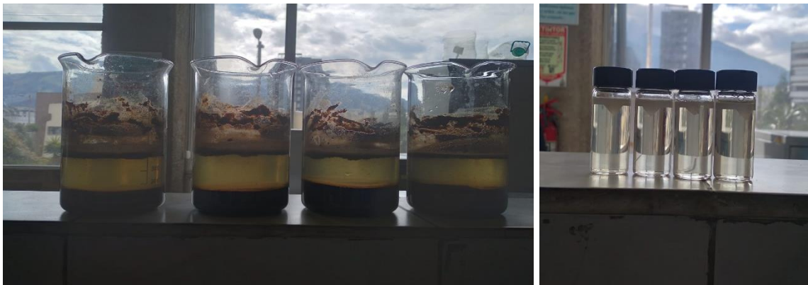
Figura 30. Tercera prueba de tratabilidad (Dosis óptima de floculante)
