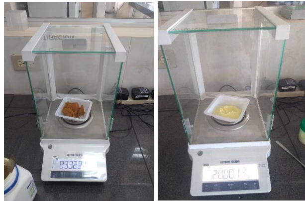
Figura 27. Pesaje de \text{FeCl}_3 y PAC para soluciones al 5% y 4%, respectivamente.
