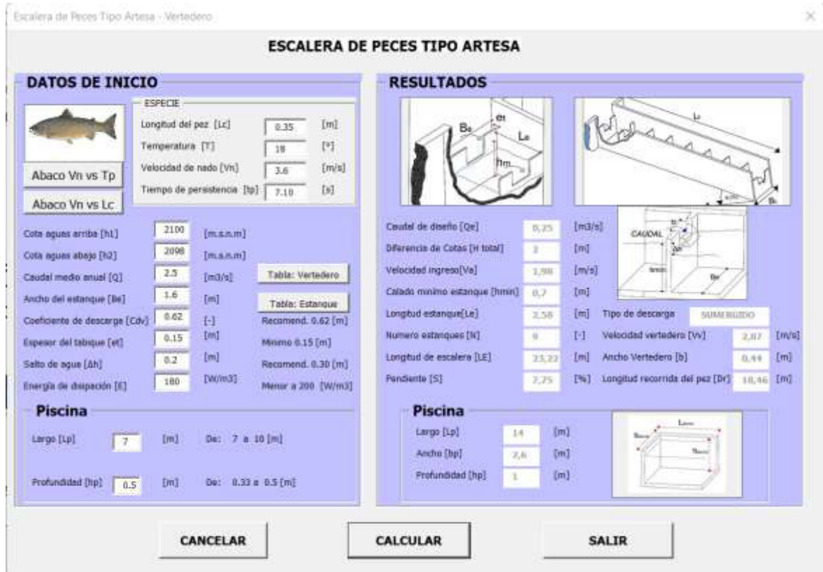
Figura N° 63: Resultados del ejemplo práctico para dimensionamiento de la escalera de peces tipo artesa con vertedero rectangular.
