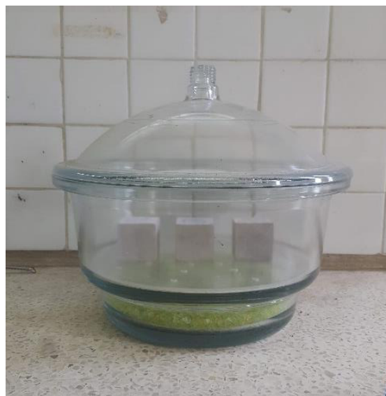
Fig. 2.31. Cubos después de secado en el horno en desecador.
