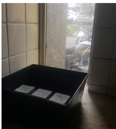
Fig. 2.40. Ciclo de descongelamiento. Fase de exposición a luz solar.
