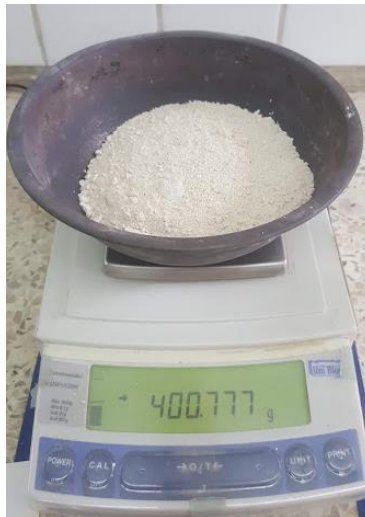
Fig. 2.1. Medición de muestra de arcilla caolinita para tratamiento térmico.
