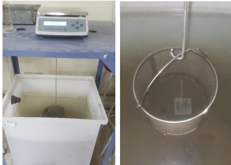
Fig. 2.34. Balanza para medición de masa aparente sumergida.
