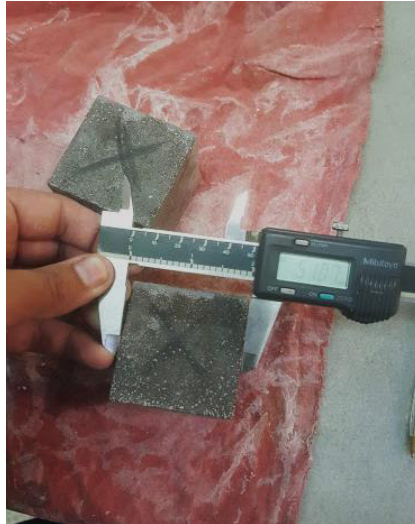
Fig. 2.44. Medición de dimensiones de cubos con calibrador.
