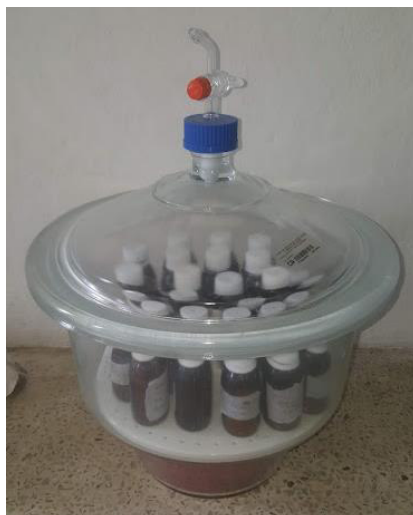
Fig. 2.8. Muestras en desecador luego de ser retirados del horno.
