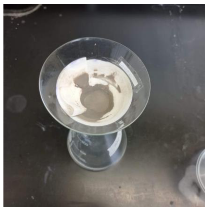
Fig. 2.7. Filtrado de la muestra con isopropanol y éter dietílico.
