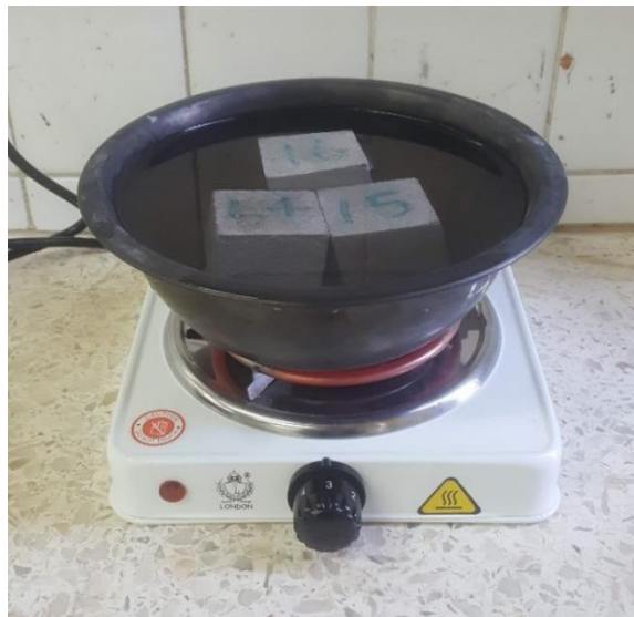
Fig. 2.33. Muestras con agua en ebullición.
