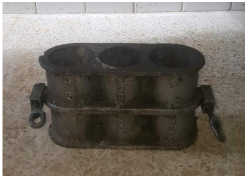
Fig. 2.21. Molde para especímenes cilíndricos D=500 mm y H=1000 mm.
