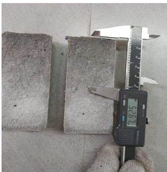
Fig. 2.29. Medición de profundidad de penetración de agua con calibrador.
