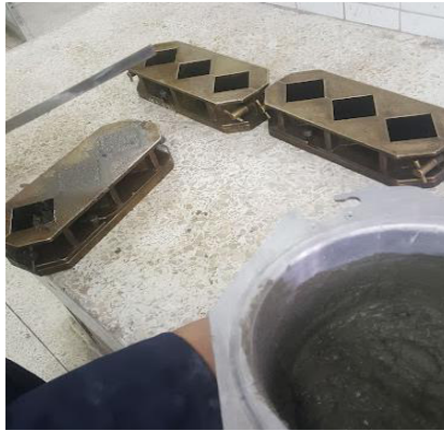
Fig. 2.17. Elaboración de especímenes cúbicos de mortero.
