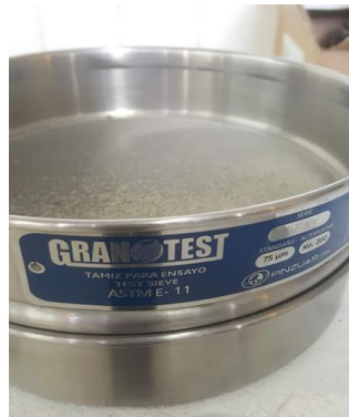
Fig. 2.4. Tamiz No. 200 para muestra triturada.
