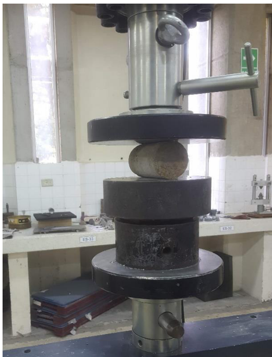
Fig. 2.28. Rotura de especímenes cilíndricos a la mitad.
