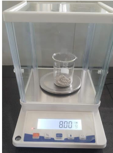
Fig. 2.5. Muestra de mortero triturado.
