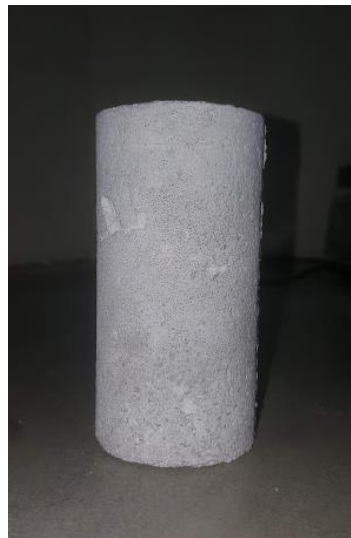
Fig. 2.25. Probeta cilíndrica para ensayo de permeabilidad.
