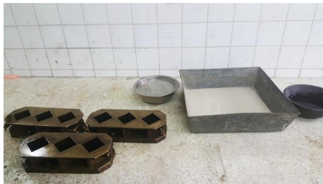
Fig. 2.12. Materiales para realización de especímenes de mortero.
