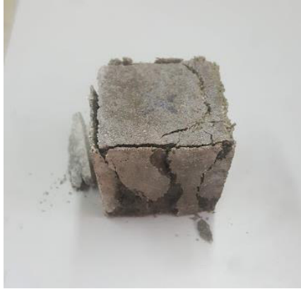
Fig. 2.46. Falla por compresión cúbica en morteros.
