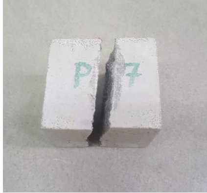
Fig. 2.36. Muestras de 56 días partidas a la mitad luego de ser expuestas al ambiente durante 7 días.
