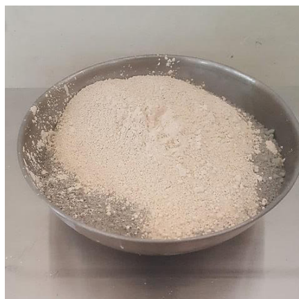
Fig. 2.14. Cemento y metakaolín en la elaboración de morteros.
