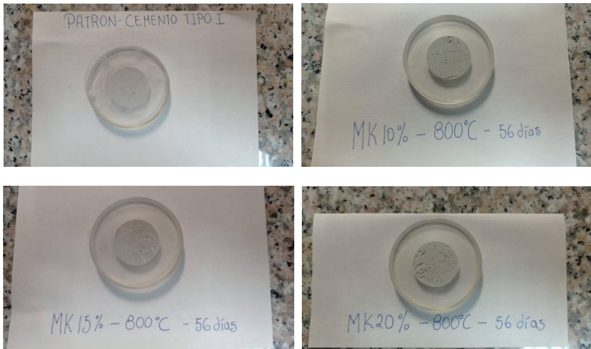
Fig. 2.10. Porta muestras con muestra de cemento Tipo I, Metakaolín 10%, Metakaolín 15% y Metakaolín 20% a 56 días.
