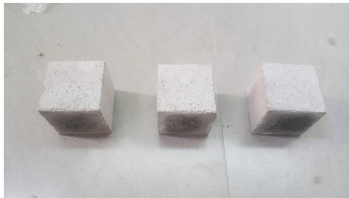
Fig. 2.42. Muestras luego de ciclo de descongelamiento.
