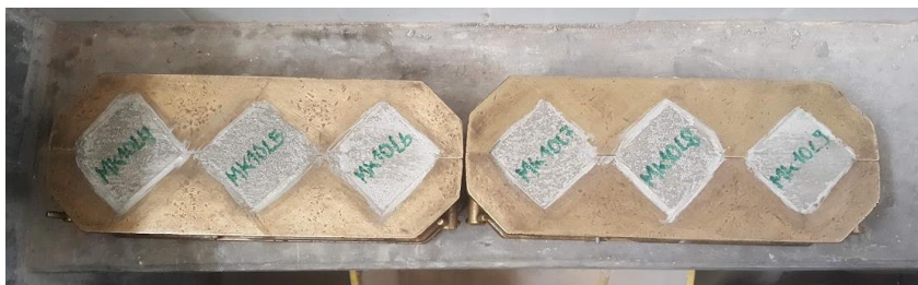
Fig. 2.19. Cubos de mortero 10% Metakaolín 24 horas después de ser fundidos.
