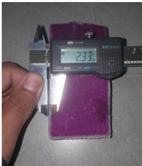
Fig. 2.38. Medición de zona carbonatada en espécimen cilíndrico con calibrador.
