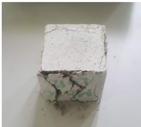
Fig. 2.43. Muestra luego de ensayo de compresión cúbica.
