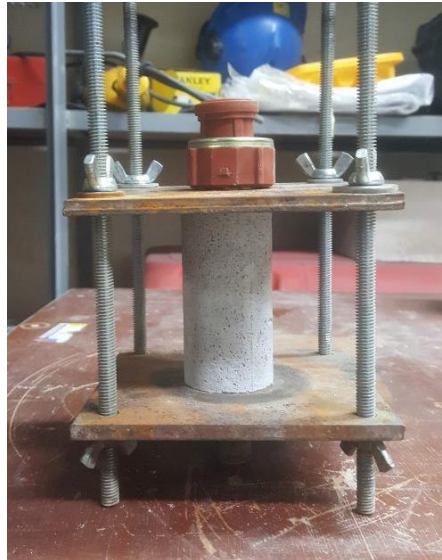
Fig. 2.26. Espécimen cilíndrico en aparato de ensayo de permeabilidad.
