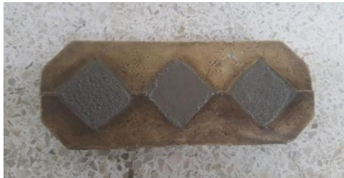
Fig. 2.18. Mortero compactado en molde.
