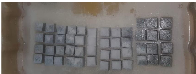
Fig. 2.20. Curado de los especímenes cúbicos en agua saturada con cal.
