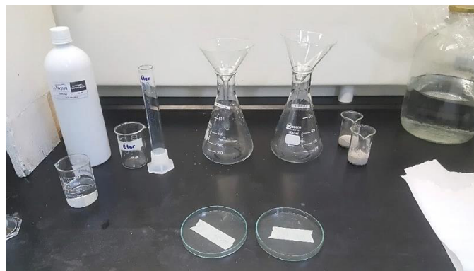
Fig. 2.6. Ensayo para detener el proceso de hidratación del cemento.
