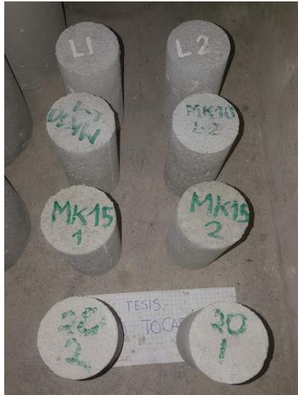
Fig. 2.22. Probetas cilíndricas de D=500 mm y H=1000 mm para ensayo de permeabilidad.
