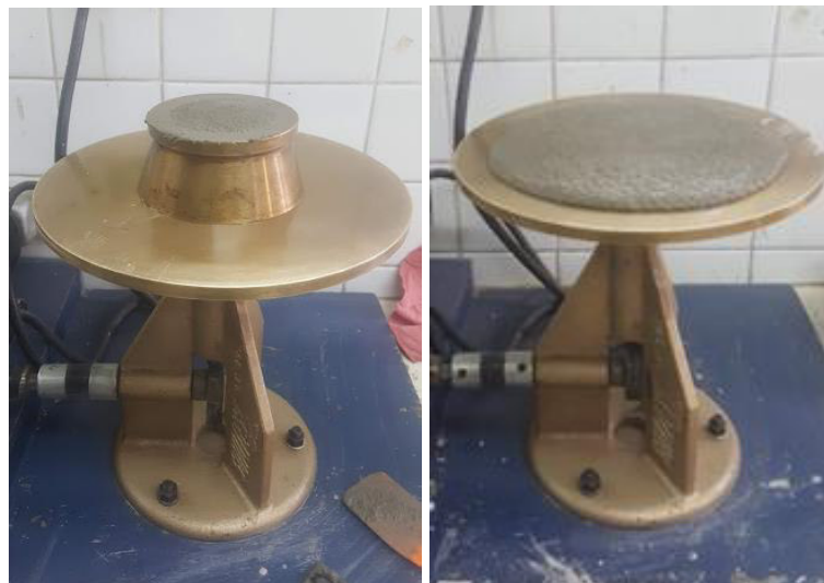
Fig. 2.15. Ensayo de Flujo.
