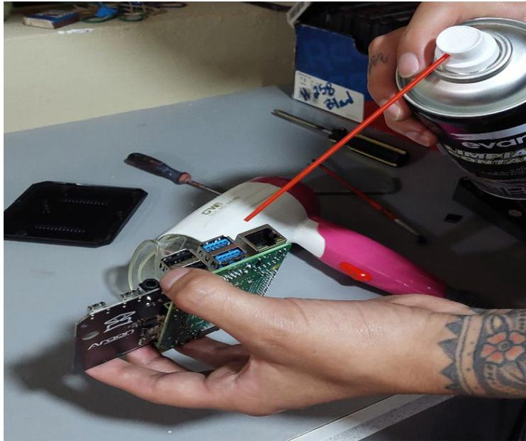
**Figura 3.103** Colocación de limpia contactos
