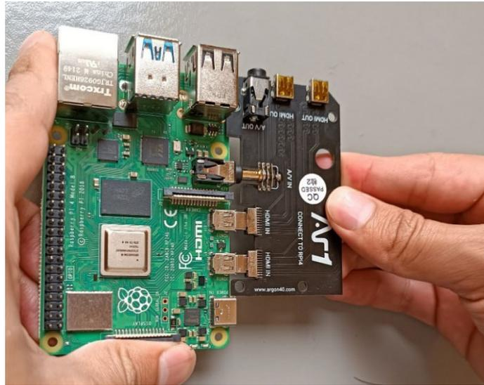
**Figura 3.61** Colocación placa *PCB*
