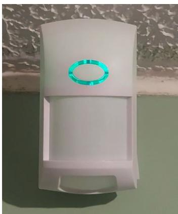
**Figura 3.80** Sensor de movimiento activado
