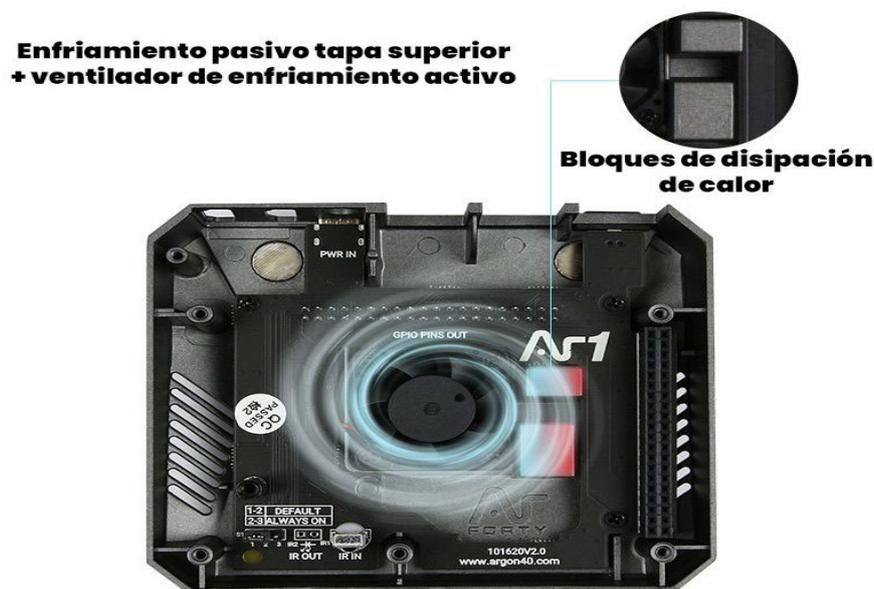
Figura 3.1 Sistema de refrigeración del estuche [20]
