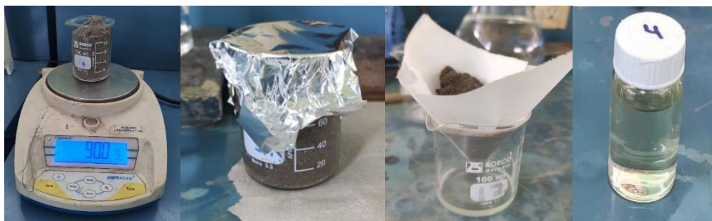
Figura 2.7. Preparación de muestras de xantato (SIPX) en arena.
