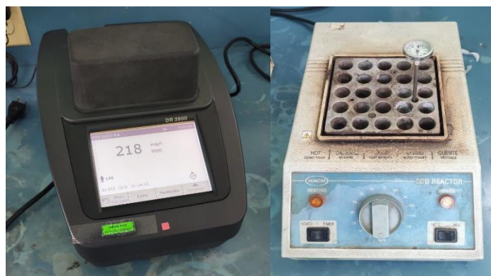
Figura 2.2. Espectrofotómetro HACH DR 2800 y Digestor HACH.
