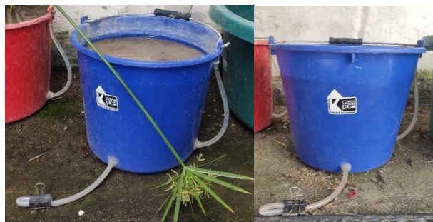
Figura 2.4. Fotos de los sistemas que simulan humedales artificiales
