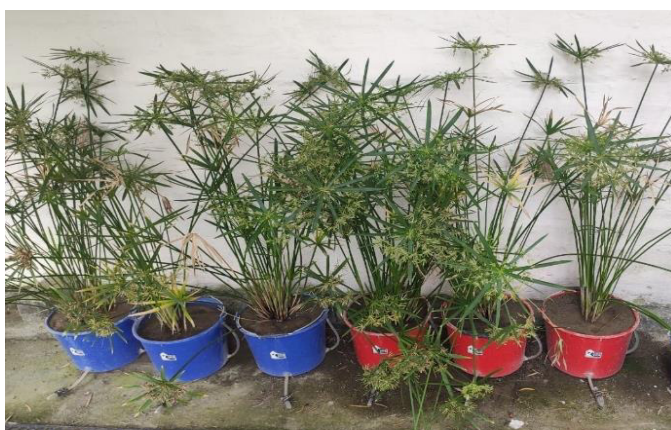
Figura 2.5. Sistemas que simulan humedales artificiales de Cyperus alternifolius a escala laboratorio.
