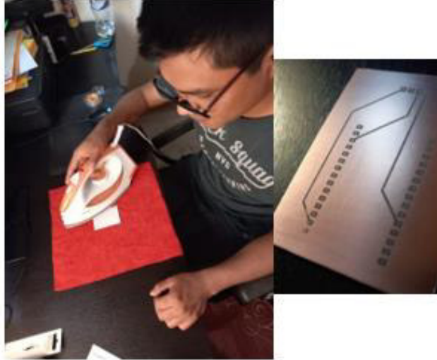
Figura 3.16 Transferencia térmica del diseño empleando el método del planchado
