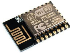
Figura 1.2 Módulo Wi-Fi ESP8266 [13]
