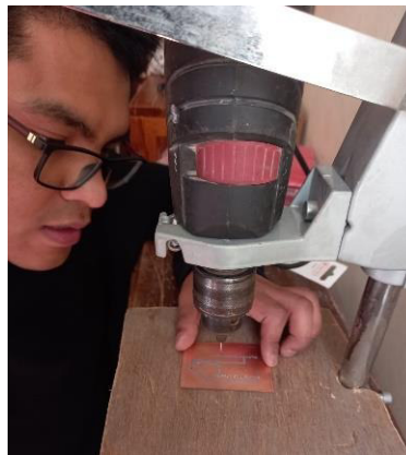
Figura 3.17 Perforación de los agujeros del diseño
