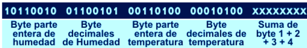
Figura 3.6 Formato del proceso de comunicación de 5 Bytes [31]
