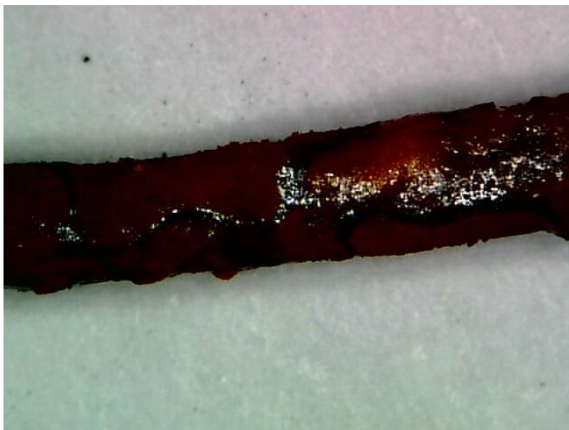
Figura 13. Foto del alambre de hierro corroído (aumento: 1000X; resolución: 1920 x 1080 P)
