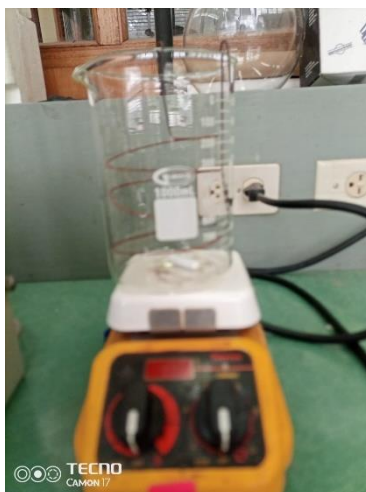
Figura 5. Foto que muestra la disposición del alambre de hierro corroído en el interior del vaso de precipitados
