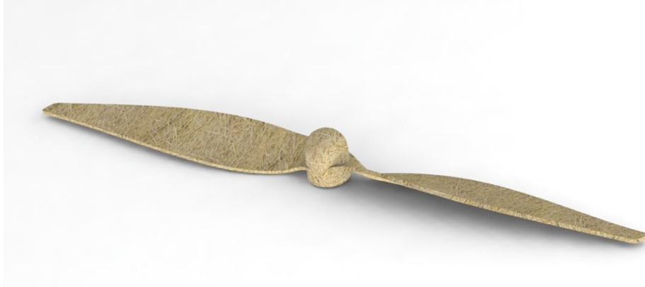
Figura 16 Modelo de la propela APC 12x6 EP de resina poliéster y fibra de bambú
