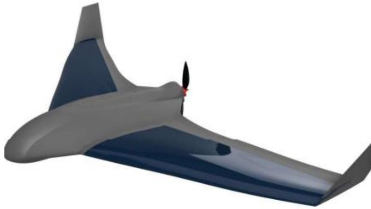
Figura 7 Diseño conceptual del UAV con propulsión convencional
