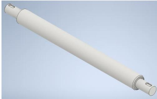
**Figura 2.8** Modelo 3D del árbol de transmisión
