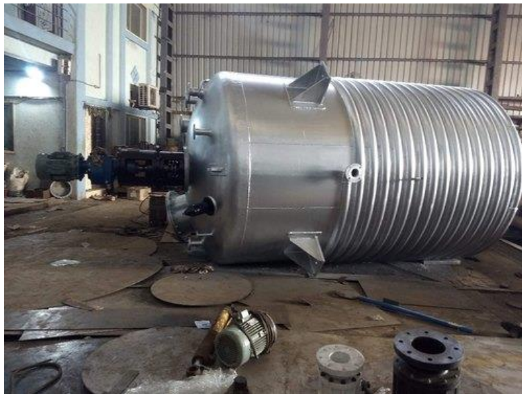
Figura 1.3. Modelo de una chaqueta embobinada de medio tubo. Fuente: (indiamart, 2019)
