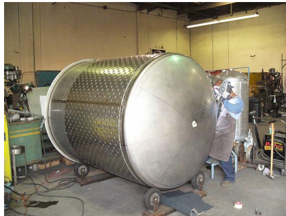
Figura 1.4. Modelo de una chaqueta con hoyuelos. Fuente: (ROYAL WELDING & FABRICATING, 2022)
