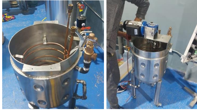
Figura 3.13. Ensamblaje del sistema de agitación. Fuente: (propia)
