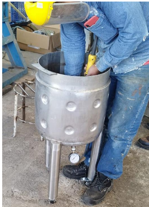
Figura 3.12. Pulido del equipo. Fuente: (propia)
