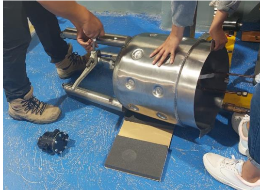
Figura 1, anexo IV. Instalación de la tubería en la doble camisa. Fuente: (propia)
