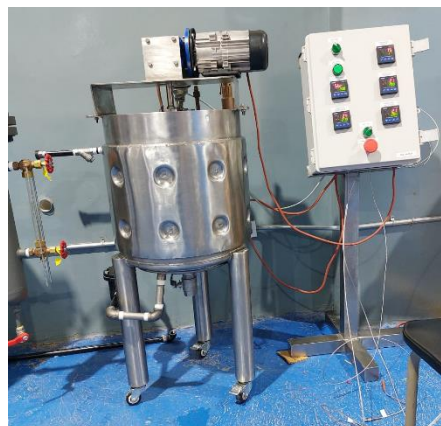
Figura 3, anexo IV. Instalación de termopares del equipo. Fuente: (propia)
