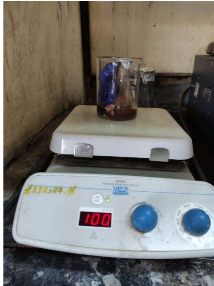
Figura 2.3. Inicio de lixiviación en plancha de calentamiento
