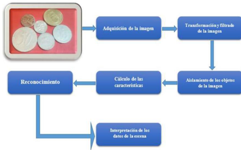
Figura 1.12. Proceso de un sistema de detección de monedas por visión artificial [14]
