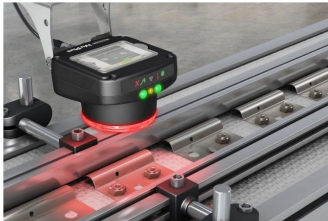
Figura 1.2. Control de calidad por medio de visión artificial [3]
