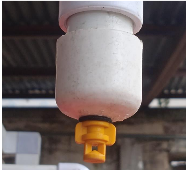
Figura 5.2 Micro Aspersor de rosca montado en tubería
