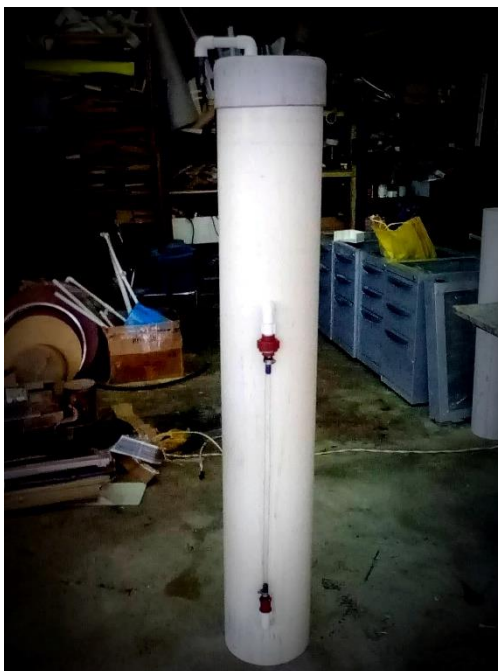
Figura 2.5 Tanque diseñado para 70 lt de capacidad.
