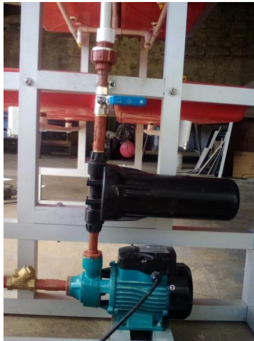
Figura 5.12 Conexión de filtro y bomba al sistema de aspersión.
