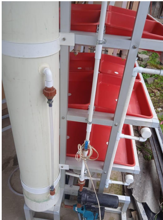
Figura 5.5 Tanque de almacenamiento montado en el módulo
