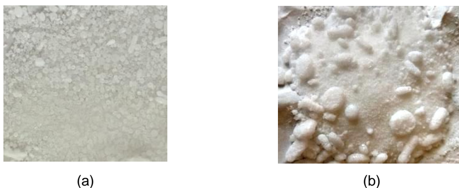
Figura 3.8. Ensayos formulación FP-2 con diferentes iniciadores (a) FP2-9 (Peróxido de benzoilo) y (b) FP2-10 (AIBN)
