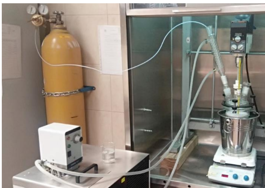
Figura 2.3. Equipo ensamblado para polimerización en suspensión (reactor cilíndrico)
