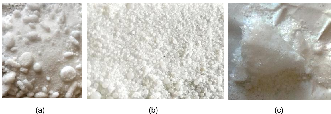
Figura 3.9. Ensayos con diferentes concentraciones de un mismo iniciador (AIBN). (a) FP2-10: 0,21 % de AIBN. (b) FP2-11: 0,15 % de AIBN. (c) FP2-12: 0,10% de AIBN.
