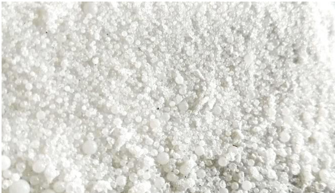
Figura 3.12 Producto de referencia FP2-11: 0,15% de AIBN, 0,4% PVA, 300 rpm, tiempo de síntesis: 3h30
