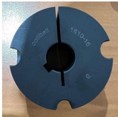
Figura 21. Casquillo de sujeción cónico seleccionado marca Optibelt.
