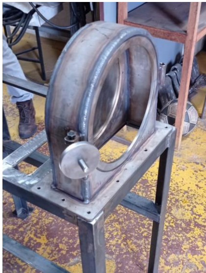
Figura 33. Cordón de soldadura de la cámara de molienda.
