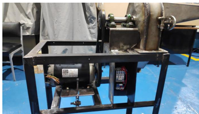
Figura 35. Montaje del motor, poleas y banda.
