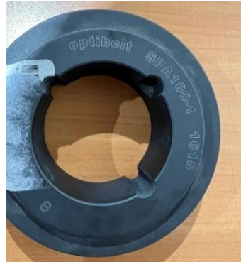
Figura 20. Polea en V de un canal seleccionada marca Optibelt.
