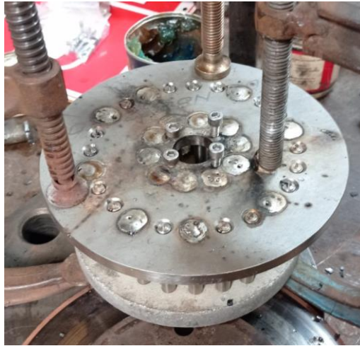
Figura 36. Relleno de soldadura para unir los pines al disco rotatorio.
