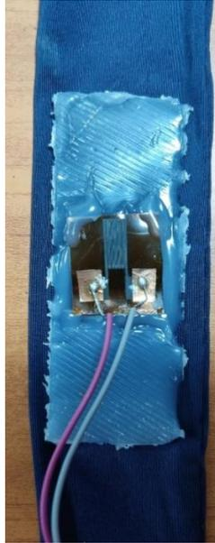
**Figura 11.** Adhesión sensor-banda textil.
