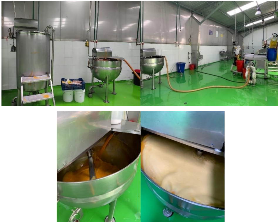
Figura 53: Proceso de homogenización y pasteurización de la pulpa
