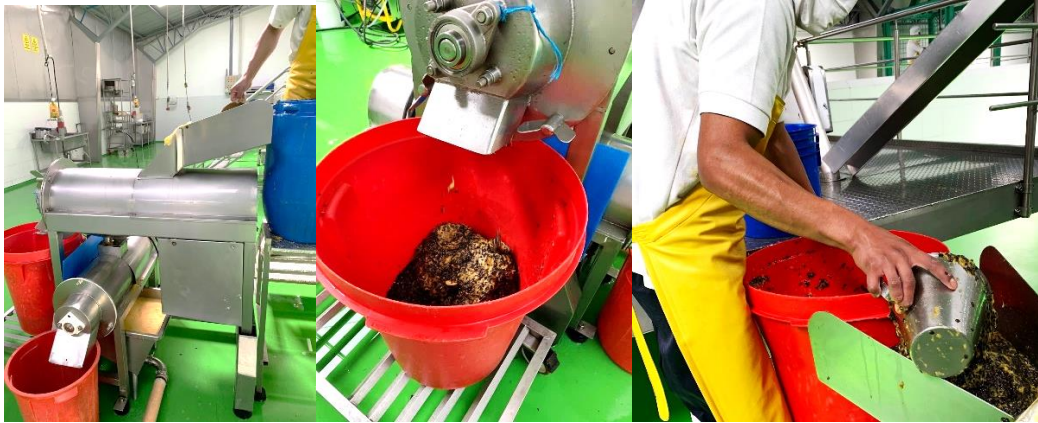
Figura 52: Proceso de Pulpeado de fruta
