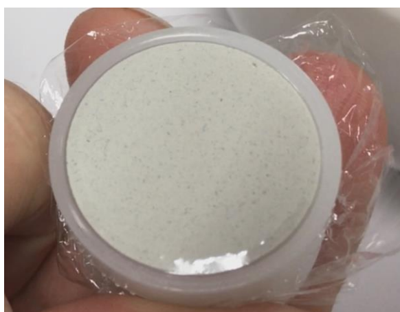
Figura 7. Capsula rellena de la roca pulverizada, lista para el análisis de XRF.
