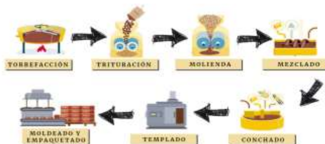
Figura 1.8. Proceso de la elaboración del chocolate.
