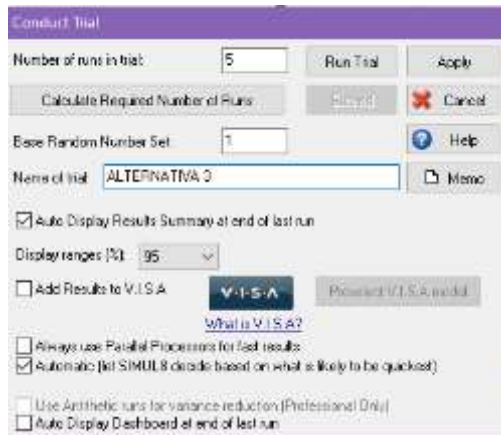
Figura 5.10. Nivel de confianza y número de corridas en el software SIMUL8 para la simulación de la distribución de planta de la solución 3.
