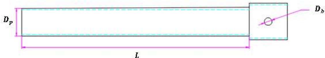
Figura 24. Sistema tubería – boquilla de distribución. [Fuente: Propia]
