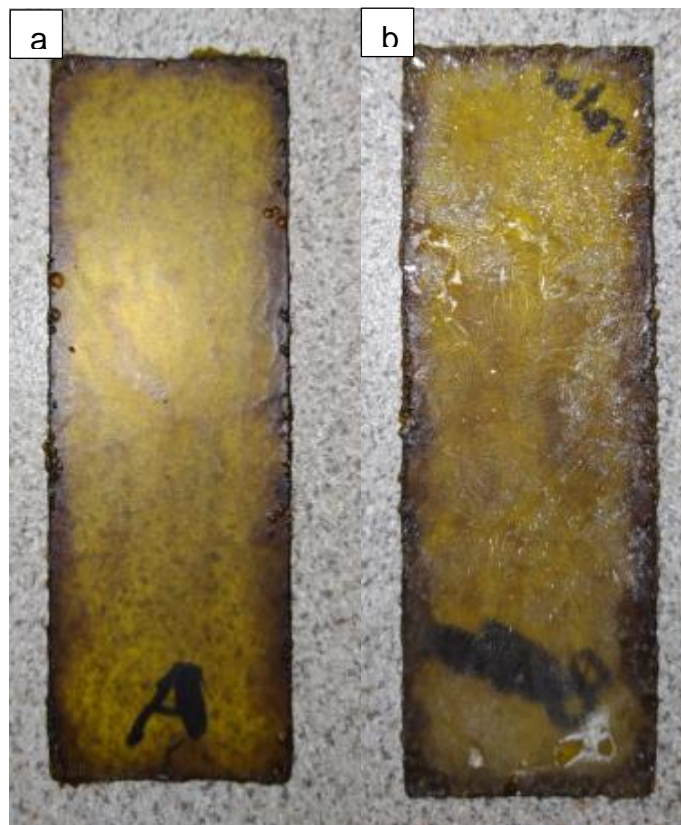
Figura 2.13: a) Muestra sin retardante de fuego. b) Muestra con retardante de fuego
