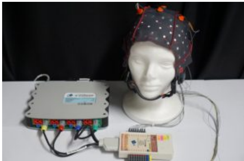
Figura 2.3: Amplificador de bioseñales gtec g.USBamp y gorro EEG.
