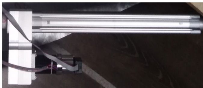
Figura 1.4. Cilindro electromecánico Festo Festo ESBF BS-32-100-10P y Motor Maxon 148877.
