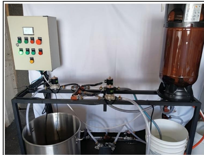
Figura 3.10 Prototipo lavador de barriles, con barril semitransparente
