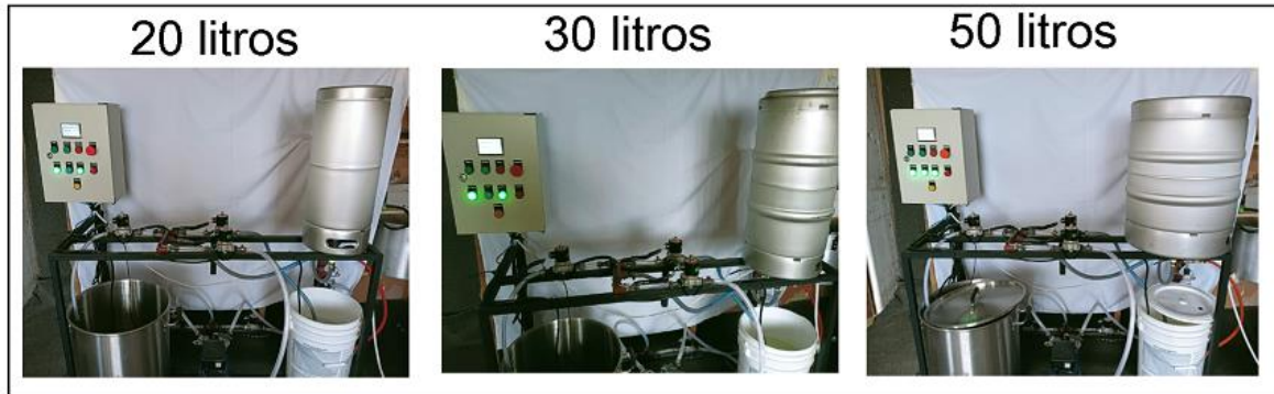
Figura 3.8 Lavado de barriles de 20, 30 y 50 litros.
