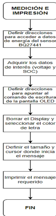
Figura 2.26. Diagrama de flujo correspondiente a medición
