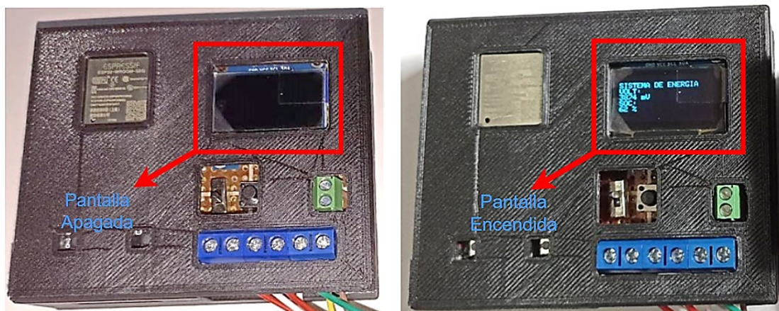
Figura 3.9. Modo de operación a) medición b) suspensión
