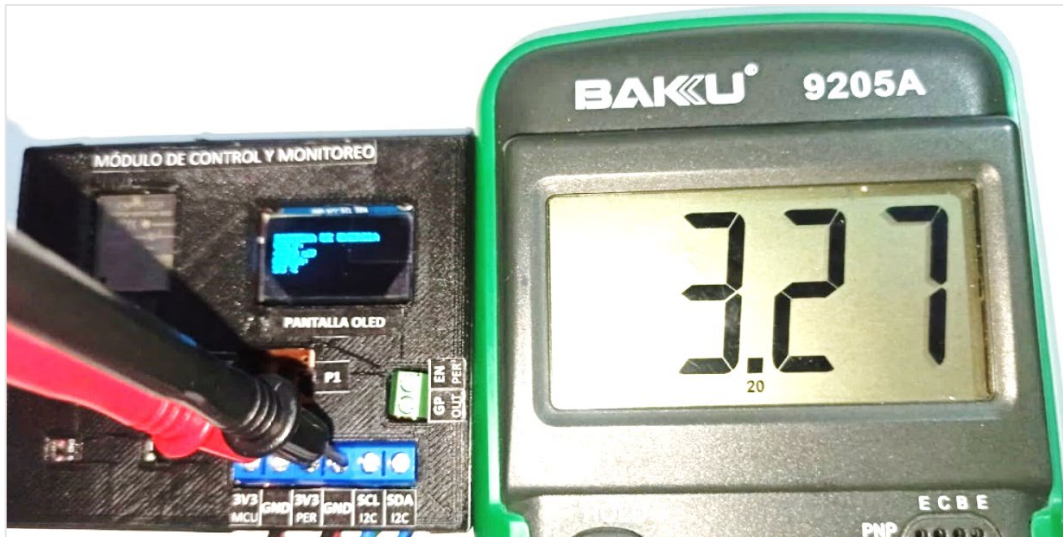
Figura 5.16. Medida de voltaje a la salida del regulador LDO.
