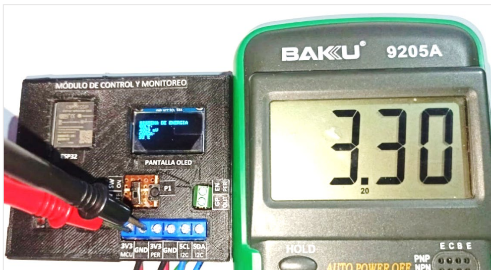
Figura 5.15. Medida de voltaje a la salida del convertidor Buck-Boost
