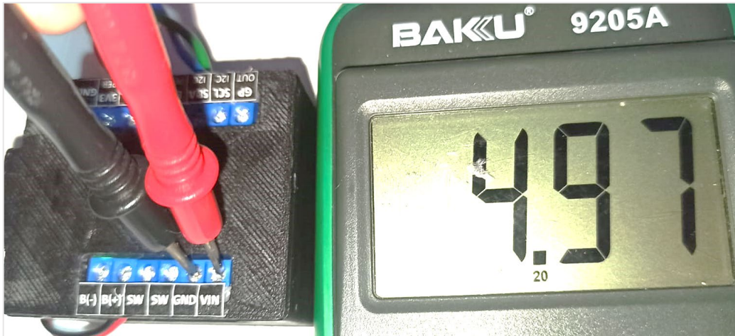
Figura 5.14. Medida de voltaje a la salida del adaptador AC-DC
