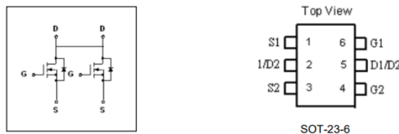
Figura 2.7. Esquema interno del circuito integrado SL8205S (2 NFET)
