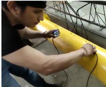
Figura 3.5. montaje de transductores.
