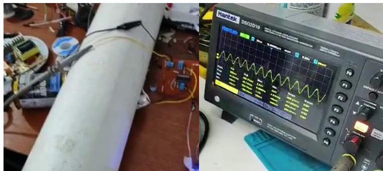
Figura 3.2. Señal de ultrasonido en el primer prototipo.
