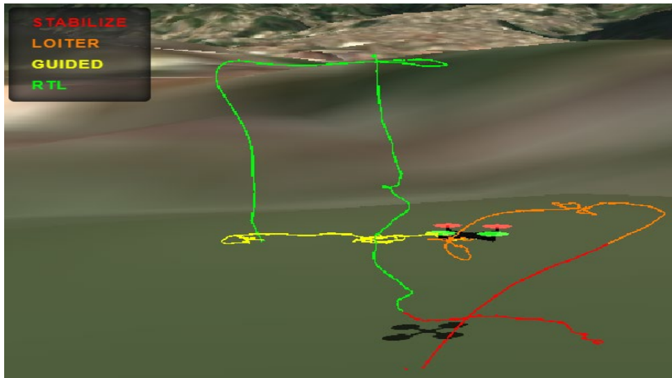
Figura IV.3 Trayectoria llevada a cabo por el dron durante la prueba 1 del tracker
