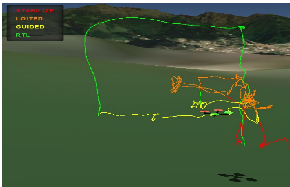
Figura IV.11 Trayectoria llevada a cabo por el dron durante la prueba 3 del tracker
