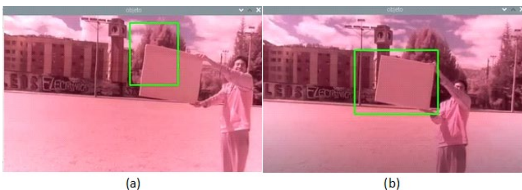
Figura 3.1 a) Resultado del detector de objetos sin modificar el balance de blancos b) Resultado del detector de objetos modificando el balance de blancos [Fuente propia].
