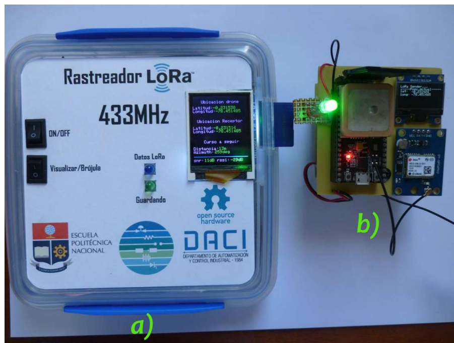
Figura 2.12. a) Prototipo electrónico receptor (TIC), b) Prototipo electrónico transmisor [Fuente propia].
