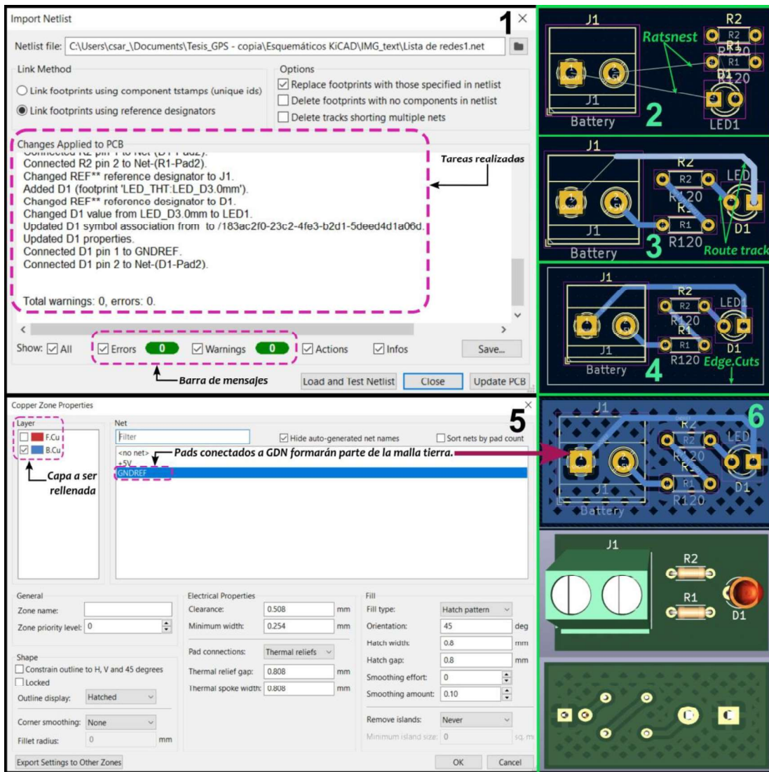
Figura 2.4. Diseño de la PCB a partir de una Netlist [Fuente propia]
