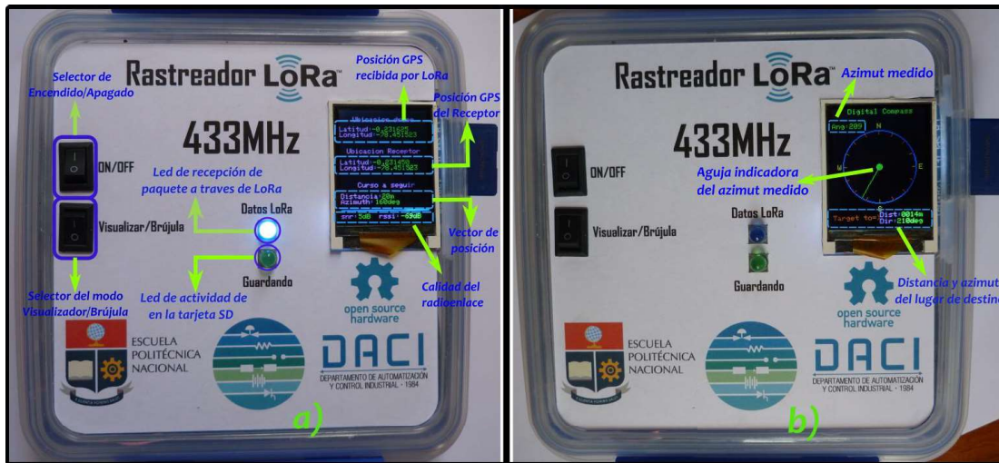
Figura 2.13. a) Controles e indicadores del prototipo electrónico receptor, b) Elementos mostrados en modo de brújula digital [Fuente propia].
