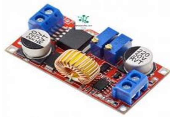
Figura 2.13 Módulo regulador de voltaje XL4015 [15]
