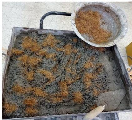
**Figura 37.** Elaboración de la mezcla de hormigón con fibra
