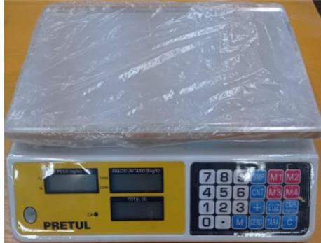
**Figura 15.** Balanza digital con apreciación de 40 kg
