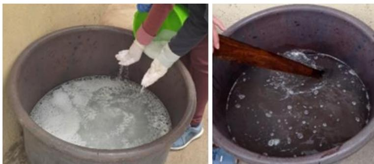
**Figura 27.** Preparación de la solución de sosa cáustica al 4%
