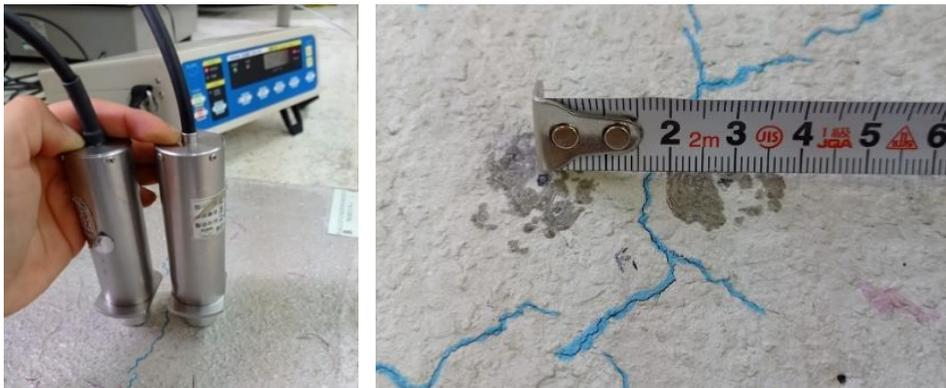
**Figura 44.** Proceso de medición de las fisuras en el laboratorio
