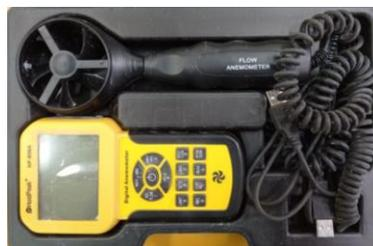
**Figura 12.** Anemómetro: sensor de temperatura y velocidad del viento
