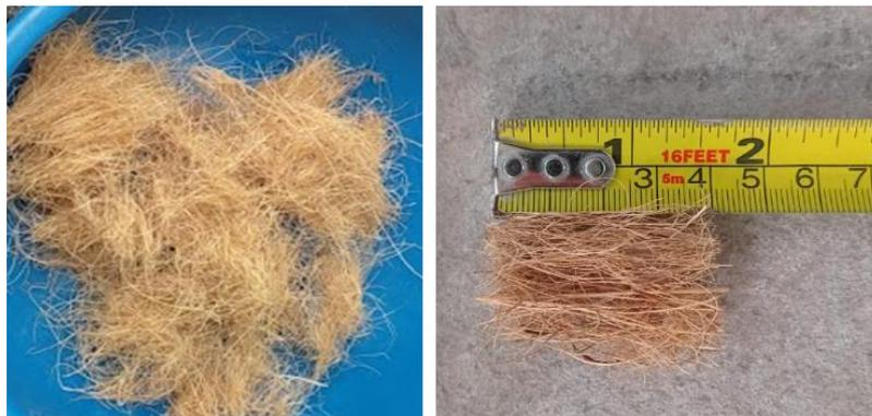
**Figura 26.** Proceso de limpieza y corte de la fibra
