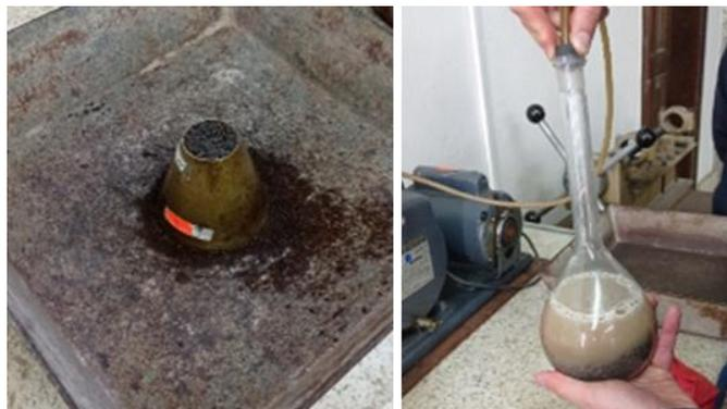
**Figura 23.** Parte del proceso de densidad relativa y absorción del agregado fino
