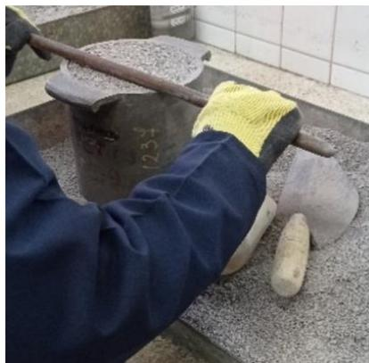
**Figura 24.** Enrasado del agregado fino para la densidad suelta
