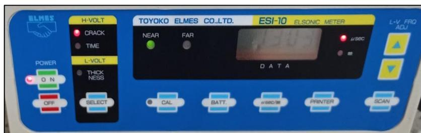
**Figura 41.** Pantalla de comandos del equipo de ultrasonido
