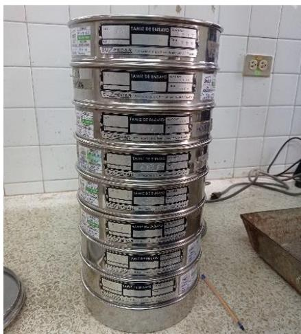
**Figura 22.** Tamizado del agregado fino
