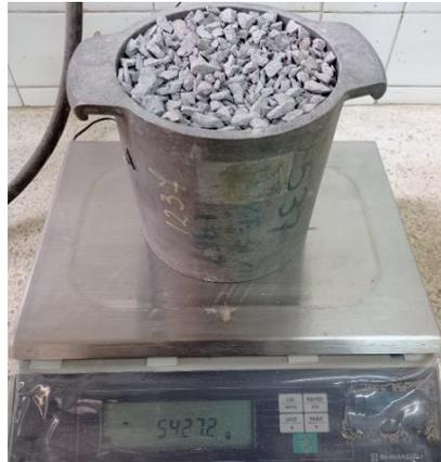
**Figura 21.** Masa del molde y la muestra en compactación
