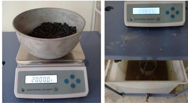
**Figura 20.** Parte del proceso para la obtención de la densidad relativa y absorción
