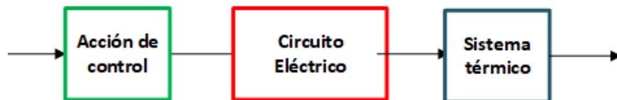
Figura 2.11 Diagrama de bloques del sistema a lazo abierto implementado en el software PLECS
