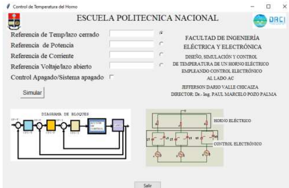
Figura 3.18 Interfaz Hombre-Máquina utilizando el software Python
