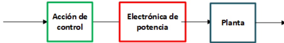
Figura 1.4 Diagrama de bloques a lazo abierto
