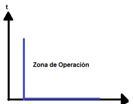
Figura 1.11 Características tiempo corriente del relé de corriente definida
