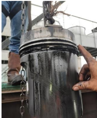
Figura 3.22. Rines del cilindro 3 MDU 2 sin problemas.
