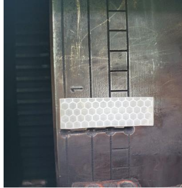
Figura 2. 2. Cinta Reflectiva colocada en el volante del cigüeñal. Fuente: (CELEC EP SACHA, 2021-2022)
