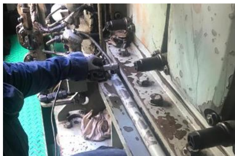
Figura 2.11. Transductor colocado horizontalmente en la base del motor
