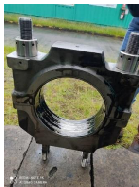
Figura 1.10. Cabeza de Biela 3, Motor 2 Hyundai 9H21/32 de la Central Sacha
