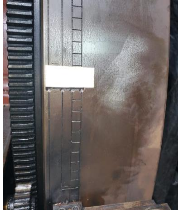
Figura 2.5. Cinta reflectiva colocada en una parada del motor
