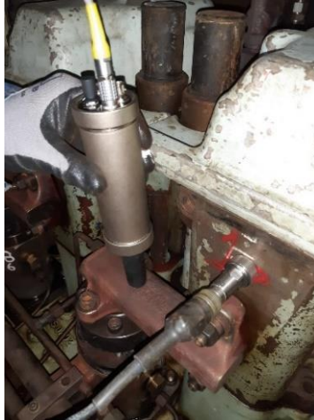
Figura 2.9. Sensor de ultrasonido colocado en el bloque de alta presión.
