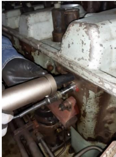
Figura 2.8. Sensor de ultrasonido y acelerómetro colocado en la pared de la culata
