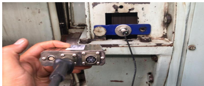
Figura 2. 4. Sensor óptico conectado. Fuente: (CELEC EP SACHA, 2021-2022)
