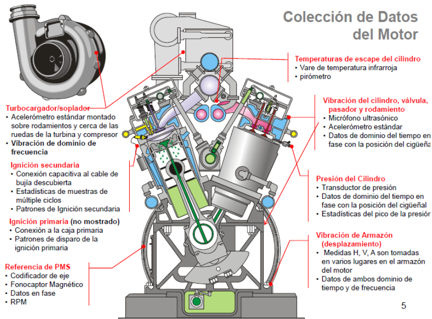
Figura 2.3. Puntos estratégicos de medición según Windrock.
