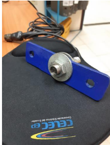
Figura 2. 3. Sensor óptico. Fuente: (CELEC EP SACHA, 2021-2022)
