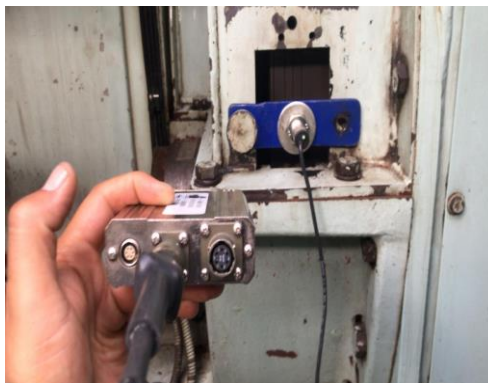
Figura 2.4. Sensor óptico conectado en el volante del cigüeñal.
