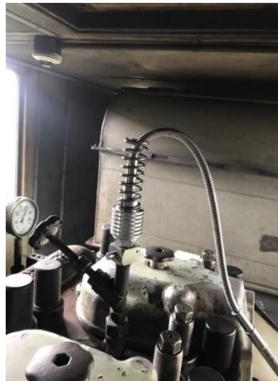
Figura 2.6. Sensor de presión conectado en la válvula de la salida de gases de escape.
