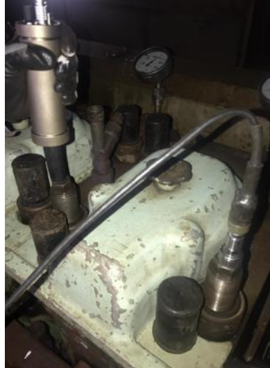
Figura 2.7. Sensor de ultrasonido colocado en el esparrago izquierdo de la culata y acelerómetro colocado en el esparrago derecho de la culata.
