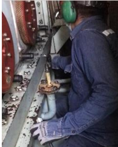
Figura 3. 2. Marcación en un punto de medida en la base del motor Hyundai
