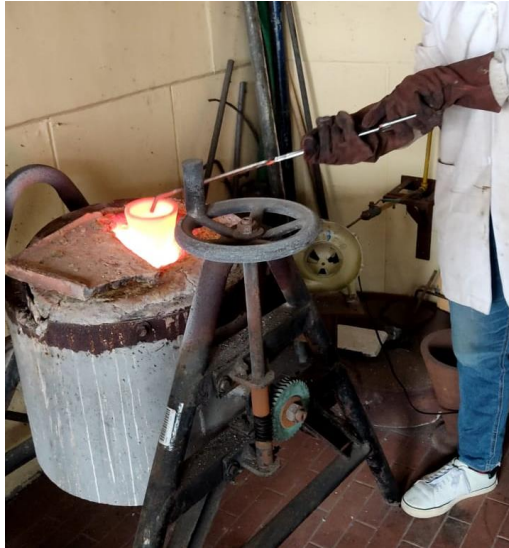
Figura 2.9. Etapa de fundición
