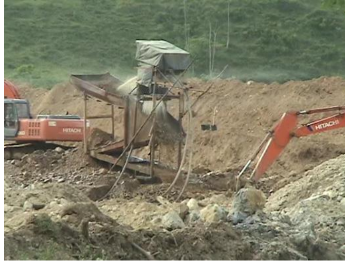
Figura 3.1. Concentrador tipo Zeta para la recuperación de oro aluvial en Zaragoza, Colombia. (Veiga & Gunson, 2020)
