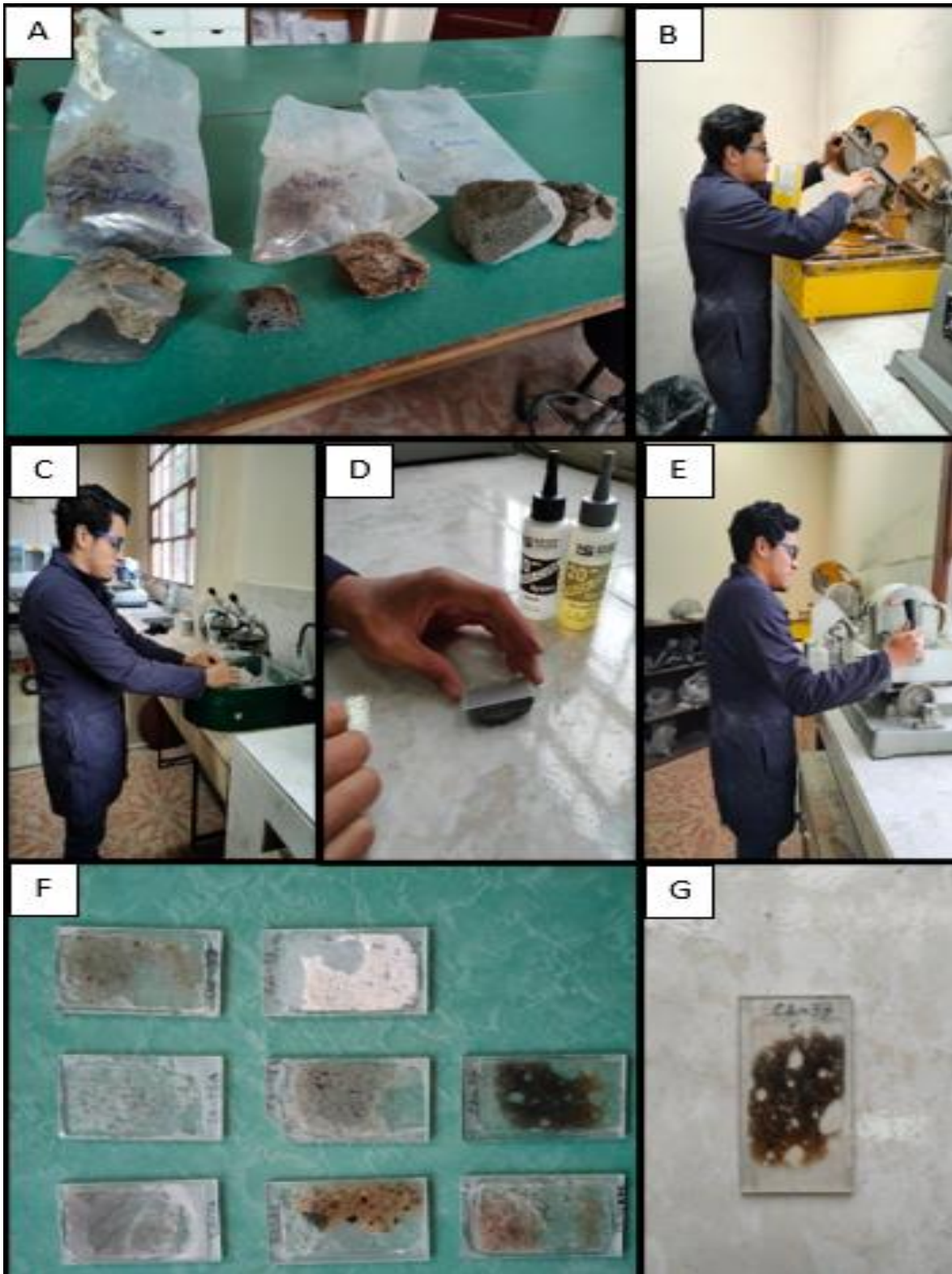
Figura 8. A. Muestras de roca para realizar láminas delgadas. B. Corte de las rocas en forma de chip. C. Puliendo una cara del chip. D. Pegando la cara del chip pulida al portaobjetos. E. Cortando y puliendo el chip hasta un espesor aproximado de 3 micras. F y G. Láminas delgadas terminadas.
