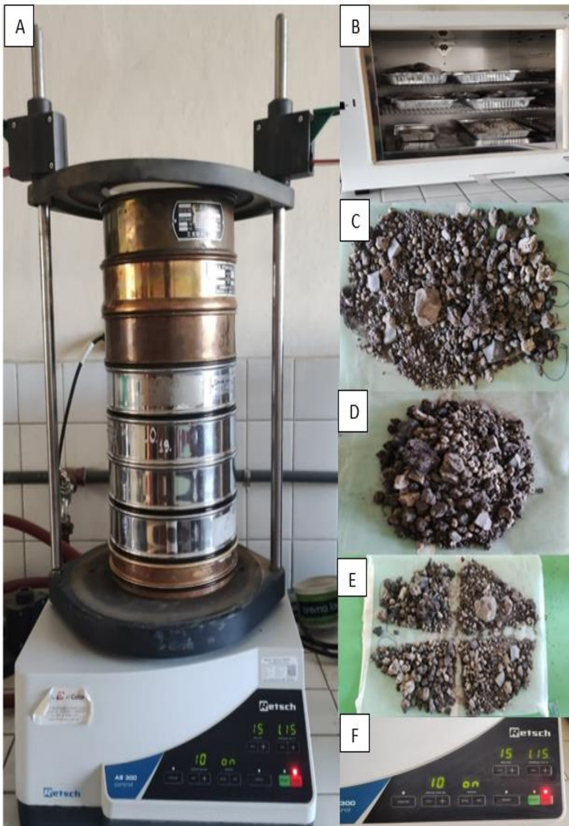
Figura 9. A) Tamices ordenados. B) Secado de muestras. C), D) Y E) Proceso de cuarteo. F) Programación de la tamizadora.
